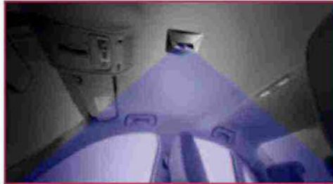
Una soluzione di sterilizzazione dell'abitacolo basata su tecnologia LED a raggi UV
