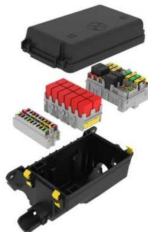
Versicherungsdose FRB für Motorraum, Relaiseinheit RB, 20 Minival Sicherungsmodul mit Kunststoffträger Im Fiat 500 Full Electric
