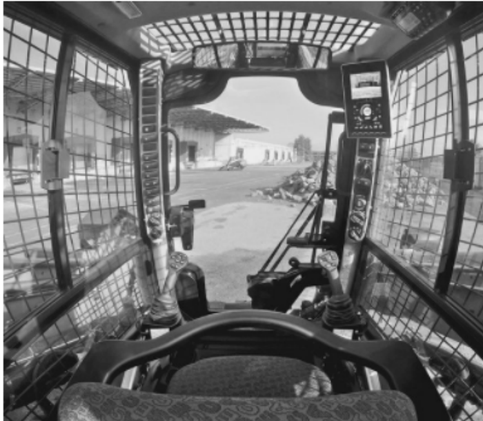
Das Black Hawk-Display von MTA gehört zu der neuen B-Serie von Case-Ladern.
