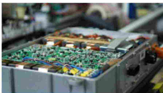
Caricabatteria di bordo della serie EVO di EDN
