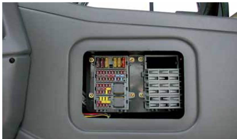
Módulos componíveis e frames multivias para as caixas de contenção dos fusíveis e relés
