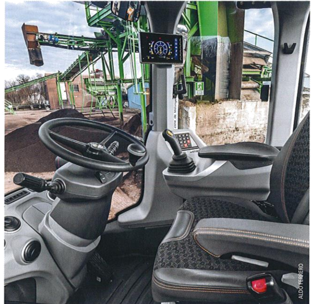
Für das Sea-Hawk-Display von MTA sprechen eine schnelle und intuitive Kontrolle sowie eine gute Lesbarkeit auch unter direkter Sonneneinstrahlung. Bei Bedarf lässt es sich darüber hinaus zu einem Monitor für die Sicht nach hinten konfigurieren.
