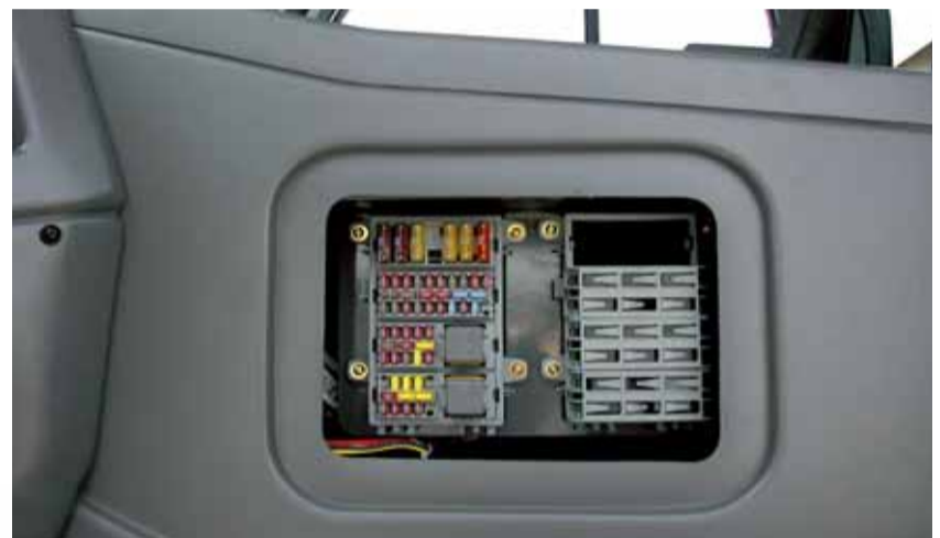
MTA Kombinierbaren Modulen für Sicherungen und Relais Modules plusieurs voies MTA pour Fusibles et Relais
