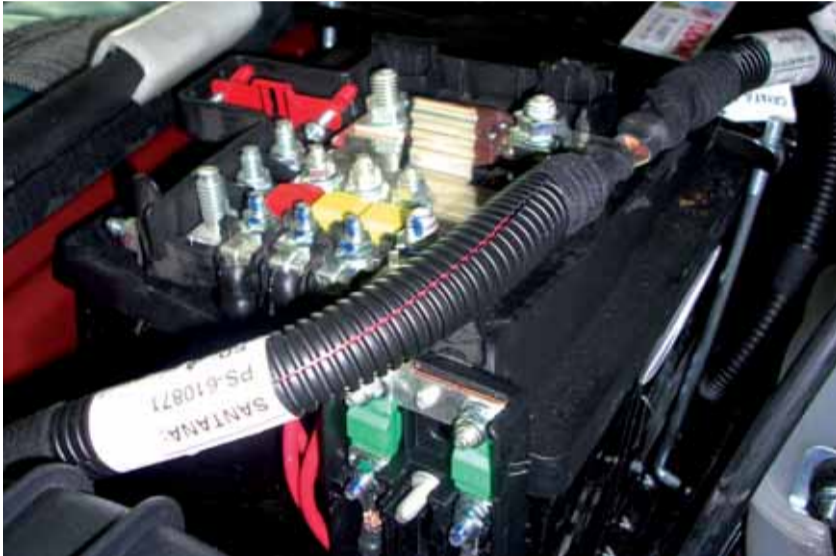
Sicherungsboxen CBA Power + CFO Boîtiers de Distribution de Puissance CBA Power + CFO
